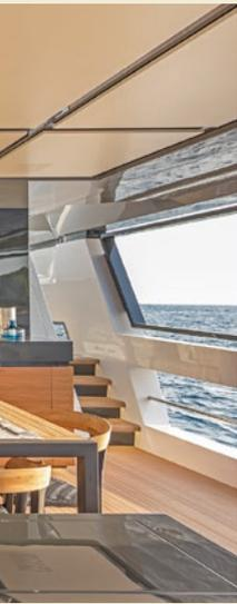
7. Los montantes que soportan la superestructura y la cubierta alta son muy aéreos y no cierran la cubierta a la visión del entorno.
