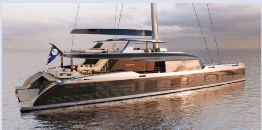
La répartition des panneaux solaires permet à ce yacht de 43 m d'avoir en permanence plus de la moitié de leur surface en exposition quasi directe.
