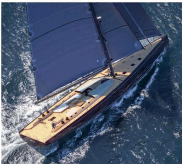
SW123: Der 108-Tonner verfügt dank Teleskopkiel über einen variablen Tiefgang (3,8–5,9 m). Ein klappbarer Spiegel verbirgt Beachclub und Tendergarage.
