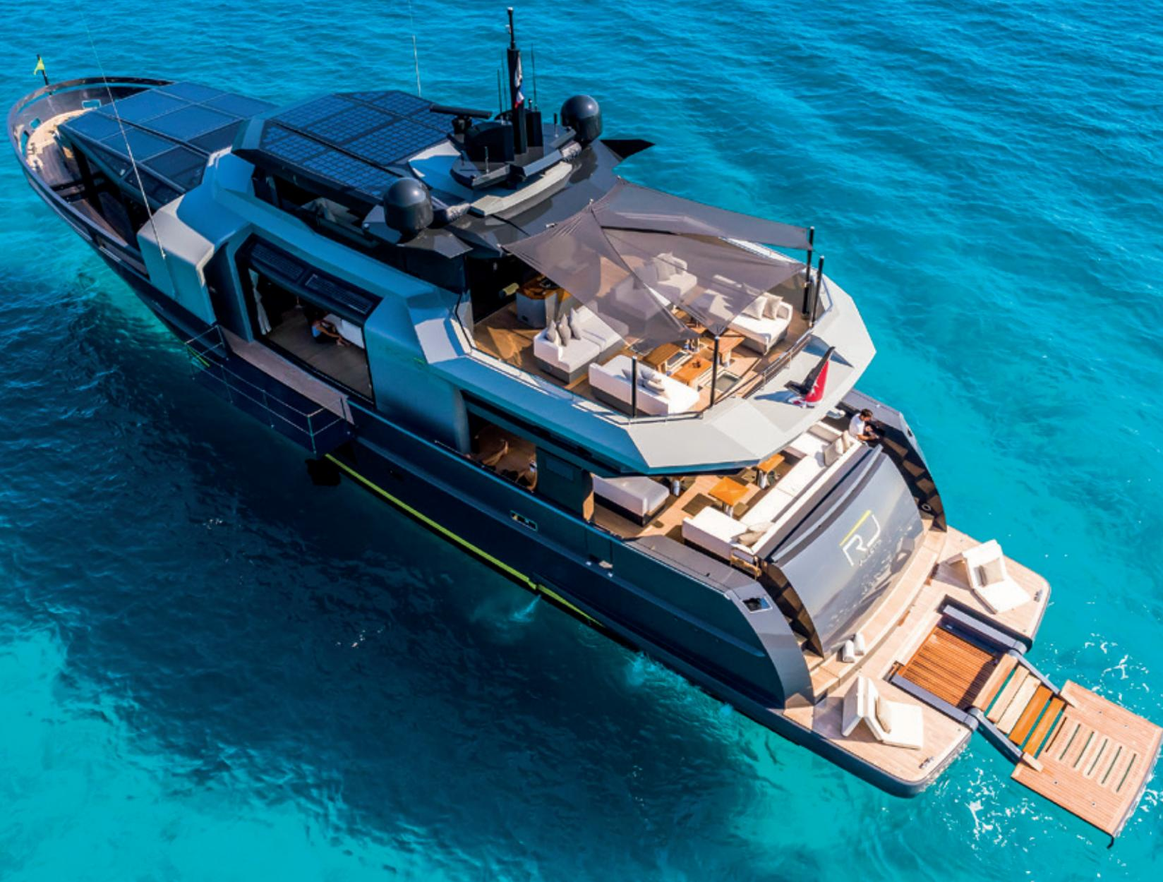
Attraverso quattro skylight inseriti nel pavimento in teak della terrazza poppiera del ponte superiore, la luce filtra sopra la zona conversazione del grande pozzetto del ponte principale. La vasta area conversazione può essere ombreggiata da tendalini sostenuti da pali in carbonio.
