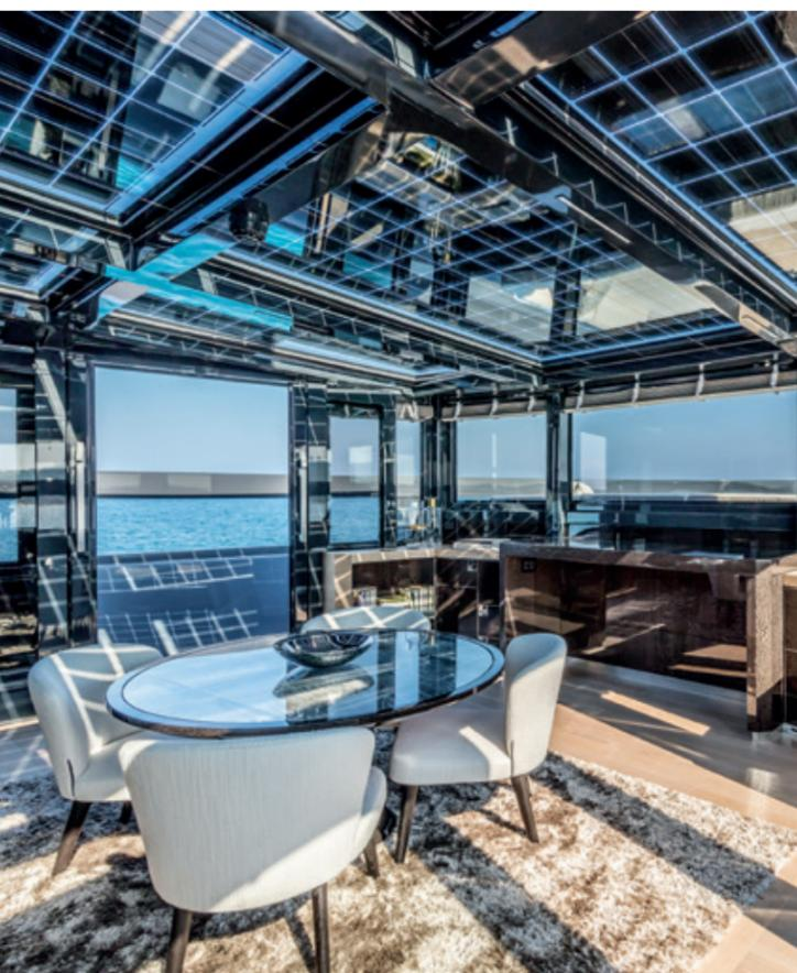
I pannelli in vetrocamera prodotti da Schüco, utilizzati per la prima volta sull'*Arcadia 85*, modello con cui ha debuttato il marchio, sono costituiti da un vetro extra-clear accoppiato a un vetro grigio con interposte cellule fotovoltaiche e da uno strato interno realizzato mediante accoppiamento di vetri con trattamento basso emissivo. L'intercapedine che separa i due livelli contiene kripton, il miglior gas inerte per simili applicazioni.
